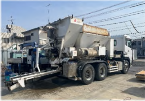
① 材料攪拌 (左：連続式モバイルコンクリートミキサー、右：バッチ式ミキサー)
