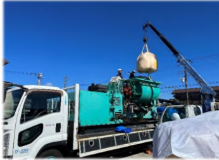
① 材料攪拌 (左：連続式モバイルコンクリートミキサー、右：バッチ式ミキサー)
