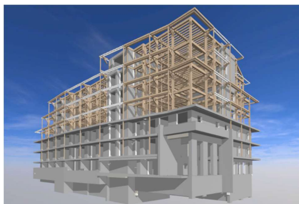
木造+RC造 ハイブリッド木造 モデル図
