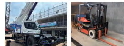
バッテリー式フル電動ラフテレーンクレーンの採用 電動フォークリフトの採用
