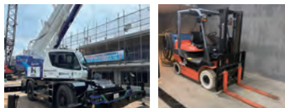
バッテリー式フル電動ラフテレーンクレーンの採用 電動フォークリフトの採用
